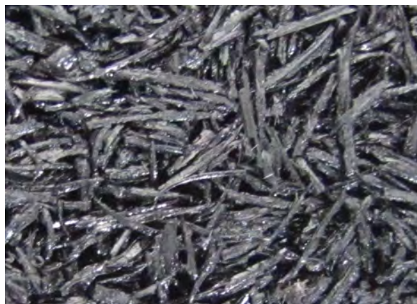
La structure nettement plus ouverte des dalles élastiques Regupol® RG 520
